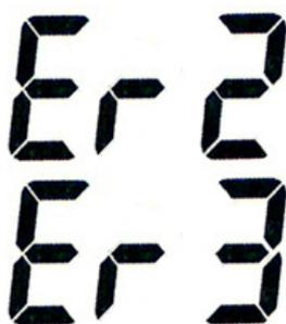
«Er2» отображается, когда температура окружающей среды меняется быстро. «Er3» отображается, когда температура окружающей среды находится вне диапазона 0...+50 °С.
